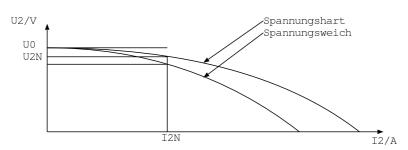
U0: Leerlaufspannung am Ausgang (U2)
